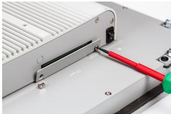
Der Slot für die CFast-Karte befindet sich oben auf der Rückseite des Panel PCs. Er ist mit einem Abdeckblech verschlossen.
