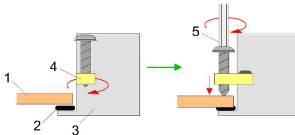
1. ➤ Stecken Sie Ihren Panel PC [3] von der Frontseite durch den Frontplattenausschnitt [1], bis dieses mit der Dichtung [2] aufliegt.
